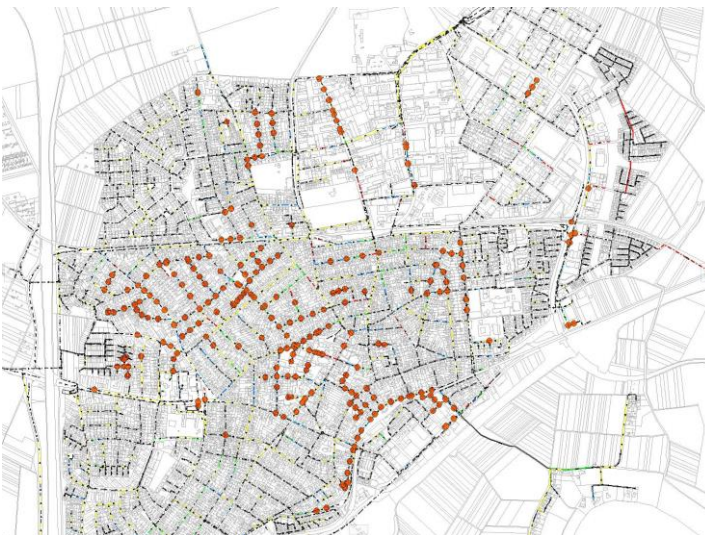
Bild 4 Überstausituation Viernheim für die Wiederkehrzeit T = 5 a. Anzahl der überstauten Schächte = 262, Maximalvolumen = 4.306,6 m 3
