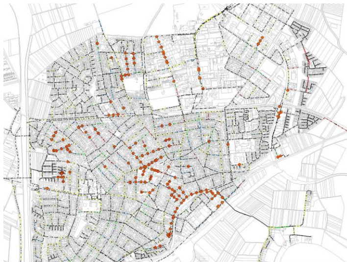
Bild 7 Überstausituation Viernheim für die Wiederkehrzeit T = 5 \text{ a} , nachdem die Maßnahmen der ersten Sanierungspriorität umgesetzt wurden. Anzahl der überstauten Schächte = 172, Maximalvolumen = 2.043,2 \text{ m}^3
