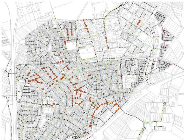
Bild 3 Überstausituation Viernheim für die Wiederkehrzeit T = 3 a. Anzahl der überstauten Schächte = 142, Maximalvolumen = 1.517,2 m 3
