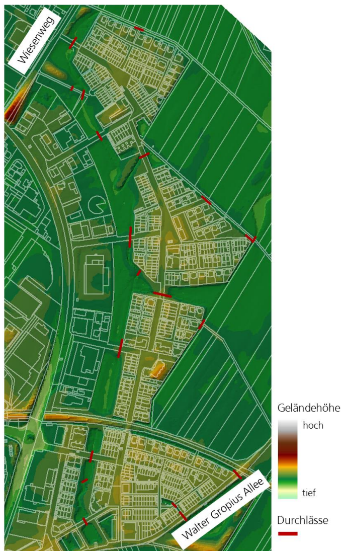
Bild 8 In den Kanalnetzmodellen zusätzlich berücksichtigte Durchlässe zur realitätsnahen Abbildung von Abflüssen auf der Oberfläche im Bereich von Grünflächen und Gräben.
